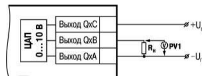
Рисунок 14 – Схема подключения нагрузки к ВЭ типа «У»
